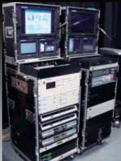
特注システムラック [ 530×770×1015 ] EIA規格以外の機材を収納したり、モ ニターケースを上部に載せるような展 開も可能です。
