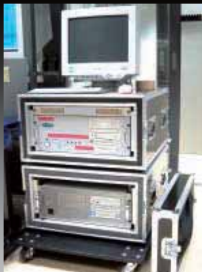
特注5Uショックマウントラック [ 630×940×337 ] 重量のある機器をマウントしている為、 標準仕様とは異なり、ベニヤ及び緩 衝材のウレタンも厚くする特注仕様 も製作可能です。
