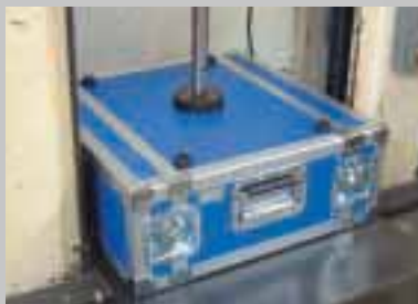
4U D360アストロボード製(板厚7mm)
