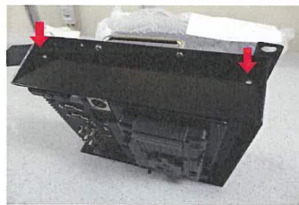
②付属のM3ネジ×2本で下部を金具に固定 (機材に付属のスタンド取付ネジでも可)
